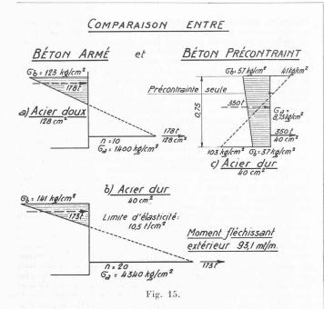
tant le même moment fléchissant de 93,1 mt, en utilisant soit des aciers doux (123 cm²), soit des aciers durs (40 cm²): la traction dans l'acier dur atteindrait 4300 kg/cm², valeur compatible avec la résistance du métal de 13 000 kg/cm² mais le béton tendu serait incapable de suivre la déformation de l'acier sans se fissurer d'une façon inadmissible.
