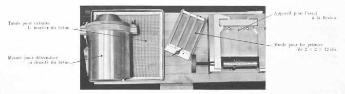
Fig. 13. — Appareillage pour la fabrication et l'essai de prismes de  $2 \times 12 \times 12$  cm en mortier extrait du béton.
