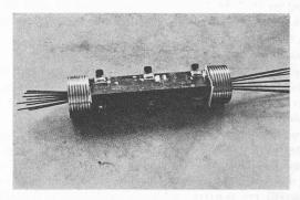
Fig. 8. — Montage pour l'essai des cônes d'ancrage.
