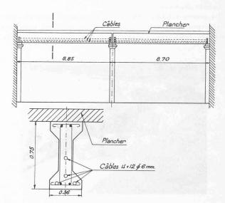
Fig. 11. — Poutre de renforcement d'un plancher. Surcharge 3,80 t/m.
