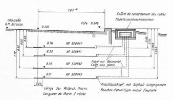
Fig. 37. — Observation des effets du gel à Ebikon. Installation des thermomètres électriques à résistance. Disposition des prises de température.
