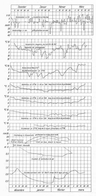
Fig. 40. — Observation des effets du gel à Ebikon. Résultats des observations de l'hiver 1939-40.
