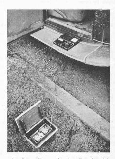
Fig. 39. — Observation des effets du gel à Ebikon. Mesure électrique des températures à quatre profondeurs différentes. Coffret de raccordement des câbles et pont de Wheatstone.
