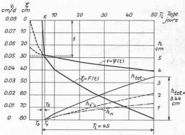
Fig. 34 b. — Calcul théorique du gonflement. Exemple nº 1,  $\xi_0 < H$ ; profondeur critique plus faible que celle de la nappe phréatique. b) Absorption d'eau, pénétration du gel et gonflement, en fonction du temps.
