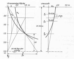
Fig. 34 a. — Calcul théorique du gonflement. Exemple nº 1, ξ<sub>0</sub><H; profondeur critique plus faible que celle de la nappe phréatique. a) Construction de la courbe e.
