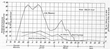
Fig. 41 b. — Observation des effets du gel à Ebikon. Gonflements et courbes intégrales des températures. — b) Hiver 1938-39.
