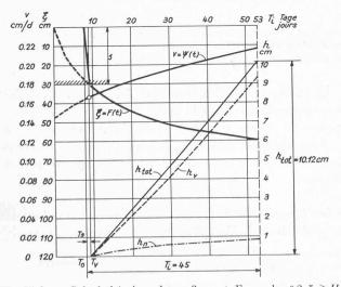
Fig. 35 b. — Calcul théorique du gonflement. Exemple n° 2,  $\xi_o > H$ ; profondeur critique plus grande que celle de la nappe phréatique. b) Absorption d'eau, pénétration du gel et gonflement, en fonction du temps.
