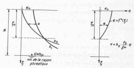
Fig. 31 (a et b). — Valeur de  $e=K_1-K_2$  en fonction de la profondeur de gel, pour  $\mathbf{x}_o < H$ .
