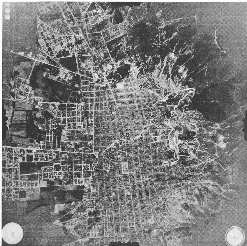
Fig. 5. — Bande de vol de l'aérottriangulation. Vue partielle de Bogota. Echelle approximative du cliché original 1 : 22 000. Les régions qui ne sont pas comprises dans les bandes de vol sont photographiées dans les mêmes conditions à l'aide de vols en damier. Ces vues aériennes sont utilisées pour l'identification des périmètres des unités organiques cadastrales, comme croquis d'investigation préliminaire du cadastre préparatoire, et servent de base à la confection des cartes préliminaires : cartes municipale, militaire et agricole.
