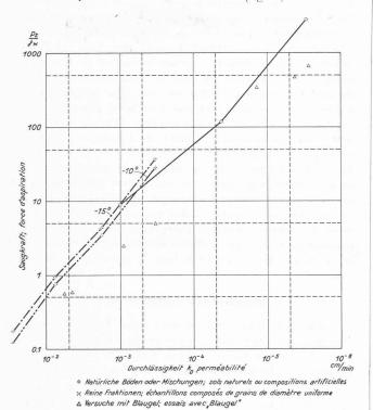
Fig. 8. — Détermination de la force d'aspiration  $\frac{P_s}{\gamma_w}$  d'après les essais de congélation de Dücker.  $\frac{P_s}{\gamma_w}$  en centimètres.
