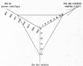
Fig. 1. — Triangle fondamental avec ses paramètres.
