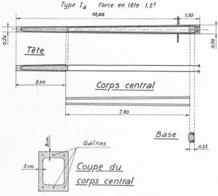
Fig. 14. — Schéma d'exécution d'un pylône.
