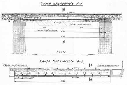
Fig. 16. — Pont-rail à Fribourg. Ensemble et coupe transversale.
