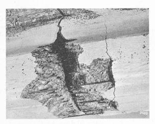
Fig. 12. — Poutrelle d'essai. Vue de la section de rupture montrant les armatures inférieures rompues.
