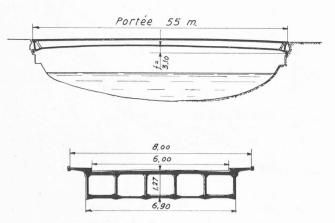
Fig. 17. — Silhouette et coupe transversale du pont de Luzancy (France) actuellement en construction.
