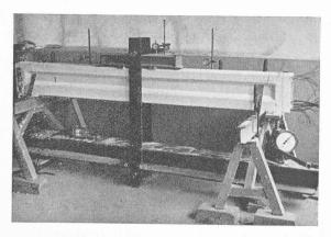
Fig. 10. — Poutrelle d'essai. Résistance à la flexion.
