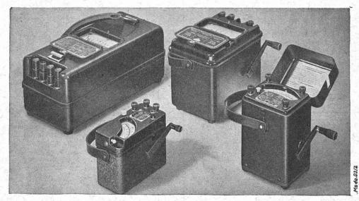
Mesureurs d'isolations, petits et grands modèles, mégohmmètres pour résistances d'isolement jusqu'à 10 000 mégohms.
