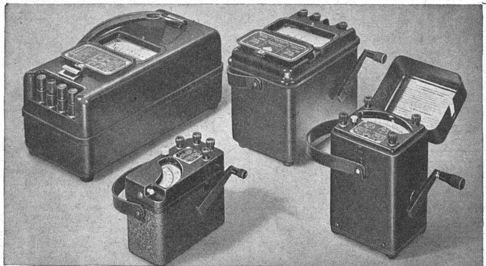
Mesureurs d'isolations, petits et grands modèles, mégohmmètres pour résistances d'isolation jusqu'à 10 000 mégohms.
