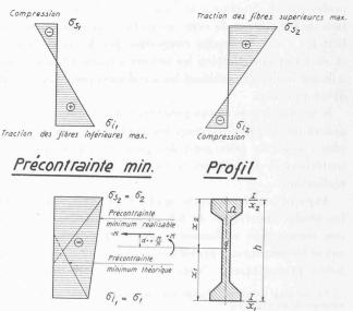
Fig. 1 et 2. — Effets des charges extérieures et précontrainte minimum nécessaire pour annuler toutes les tractions de flexion du béton correspondantes,
