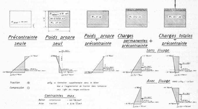
Fig. 5, — Les différents états de contrainte d'une section fléchie en béton précontraint. Les cas de charge « Précontrainte seule » et « Poids propre seul » ne sauraient se présenter séparément.
