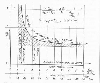
Fig. 3. — Chute de précontrainte dans le béton en fonction de la contrainte initiale dans les aciers.
