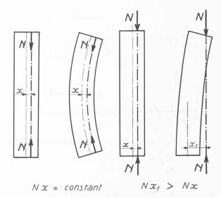
Fig. 6. — Comparaison entre une pièce précontrainte et une pièce comprimée au point de vue du danger de flambage.
