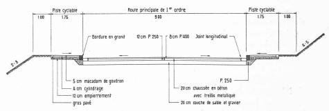
Fig 6. — Profil en travers type de la route projetée.
