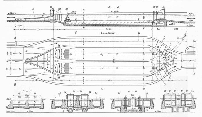
Fig. 3. — Dessableurs avec : Id et Ig: canaux intermédiaires, Di-Di: diaphragmes, Ld et Lg: canaux latéraux,  $V_3-V_3$ : vannes de sortie. Dans les bassins des dessableurs,  $V_4-V_4$ : vannes d'entrée,  $G_2-G_2$ : tranquilliseurs,  $G_3-G_3$ : grilles fines, S-S: canaux de purge, E-E: appareils-purgeurs,  $V_5-V_5$ : vannes de vidage,  $V_6-V_6$ : vannes de purge,  $V_7-V_7$ : vannes de sortie, Cd: canal de départ, Dm: déversoir, Cv: chambre des vannes, Tp: tunnel de purge. Echelle 1:600.
