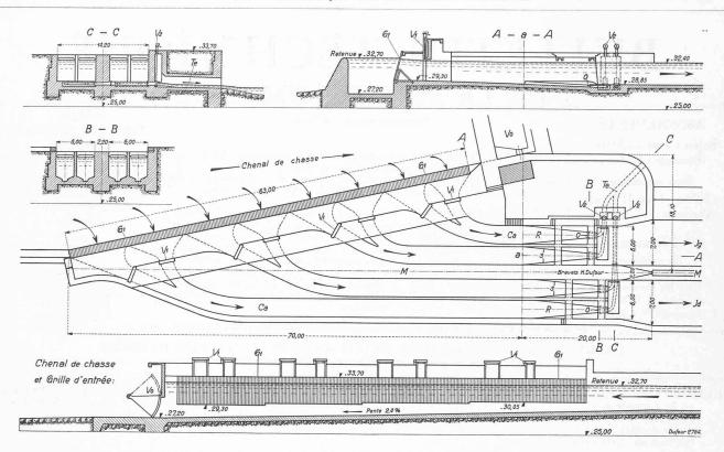
Fig. 2. — Prise d'eau et dégraveurs avec : Vo : Vanne de chasse,  $G_1$  : grille d'entrée,  $V_1 \div V_1$  : vannes d'entrée,  $Ca \div Ca$  : canaux d'amenée,  $R \div R$  : rigoles,  $s \div s$  : seuils,  $O \div O$  : orifices et  $V_2 - V_2$  : vannes de purge des dégraveurs, Te : tunnel d'évacuation, Id et Ig: canaux intermédiaires. Echelle 1 : 600.
