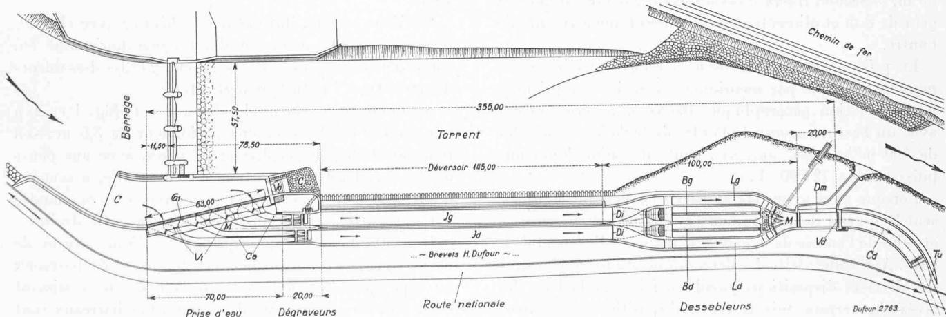
Fig. 1. — Plan d'ensemble du barrage, du chenal de chasse *C—C* et de la prise d'eau suivie : des dégraveurs, des canaux intermédiaires *Id* et *Ig*, des dessableurs, du canal de départ *Cd* et du tunnel de l'usine *Tu*. Echelle 1 : 2500.
