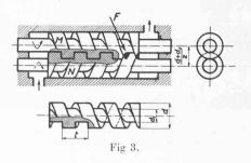
En exécutant un filet qui obture complètement la rainure et en entourant les vis d'un carter ajusté, on réalise, avec les rainures, les chambres fermées que l'on rencontre dans toutes les pompes volumétriques. Examinons l'évolution des volumes balayés.
