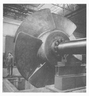
Fig. 46. — Roue Kaplan à l'équilibrage en atelier.
