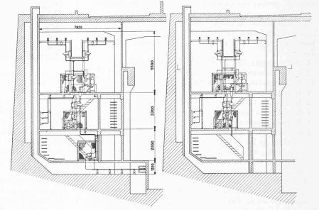
Fig. 57. — Coupe en travers d'un circuit 18 000 V d'alternateur.
