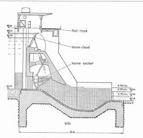
Fig. 19. — Coupe transversale du barrage. Echelle 1:600.
