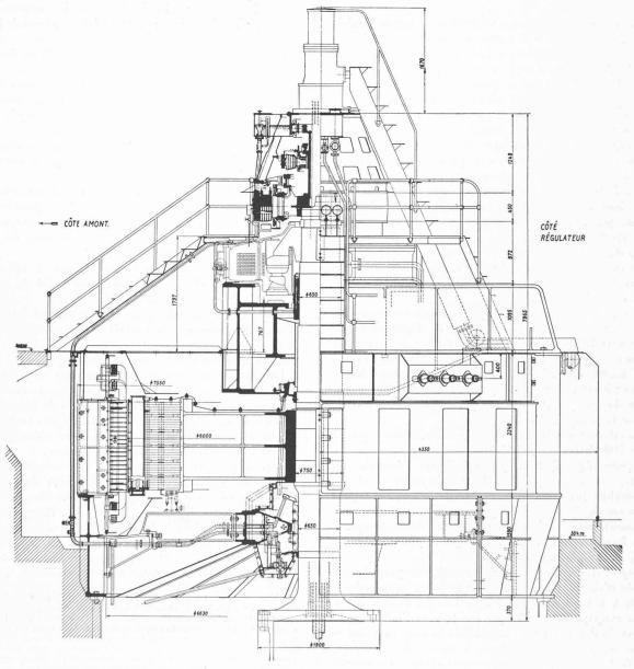
Fig. 49. — Coupe de l'alternateur. Echelle 1 : 60.
