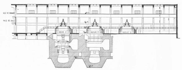
Fig. 16. — Coupe-élévation de la salle des machines. Echelle 1 : 600.
