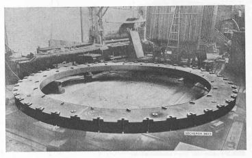
Fig. 52. — Anneaux constituant la jante du rotor.
