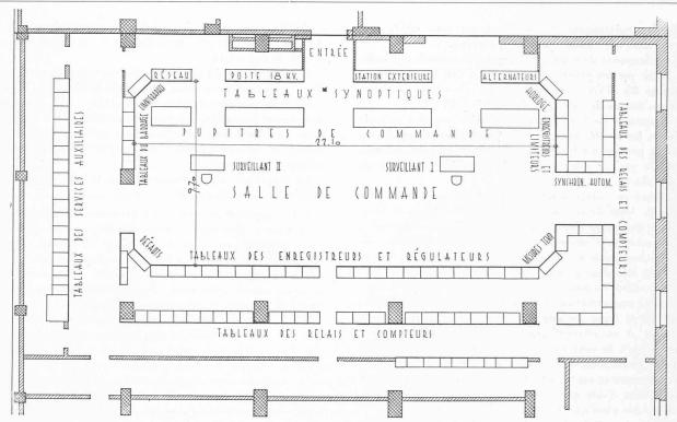
Fig. 66. — Plan de la salle de commande.
