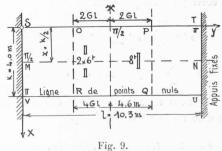
et VU, de longueur l. La série de Fourier, qui représente la flexion verticale  $\omega$  de cette dalle, supposée appuyée librement et rigidement sur son contour, s'exprime  $^1$  par la série
