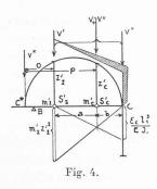
l'ellipse finale de gauche C' et de l'élasticité  $\epsilon_c$  de l'appui C. Le centre de l'ellipse du nœud  $S'_C$  se trouve sur la résultante de deux forces V' et V'', qui infligent séparément le même déplacement simple au point C; la première agit par le centre  $S'_2$  de l'ellipse finale et la seconde porte sur l'appui élastique C; les deux proportions
