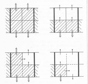
Fig. 5 à 8. — Plan schématique d'un immeuble locatif situé entre deux immeubles de disposition symétrique, de sorte que les transmissions par les mitoyens sont nulles. Les surfaces hachées indiquent les pièces chauffées et les flèches les déperditions de chaleur directes (flèches doubles) et à travers les pièces non chauffées (flèches simples).
