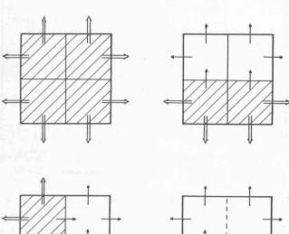
Fig. 1 à 4. — Plan schématique d'une villa montrant les déperditions de chaleur directes (flèches doubles) et à travers les pièces non chauffées (flèches simples). La surface hachée indique les pièces chauffées.
