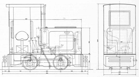
Fig. 2. — Croquis-type de la locomotive Diesel-mécanique de 25 CV.
