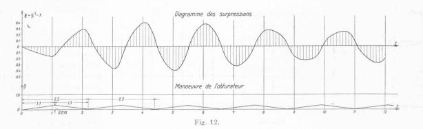
Fig. 8 à 12. — Surpressions à l'extrémité aval d'une conduite, produites par différentes manœuvres brisées de l'obturateur.  $(\rho_o=0.5, \quad \sigma=0.3077, \quad \overline{\theta}_1=0.9).$
