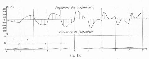
Fig. 14 et 15. - Surpressions à l'extrémité aval d'une conduite, produites par deux manœuvres brisées de l'obturateur.  $(\rho_o = 0.2, \quad \sigma = 0.7955,$  $\theta_1 = 0.8$ .
