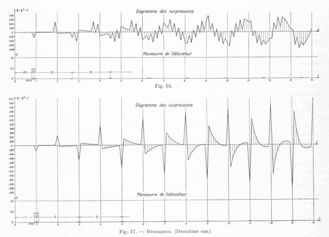
Fig. 16 et 17. — Surpressions à l'extrémité aval d'une conduite, produites par deux manœuvres isolées de l'obturateur.  $(\rho_o=0.5, \quad \sigma=0.3077, \quad \overline{\theta}_1=0.9).$
