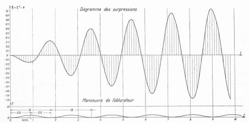
Fig. 13. — Surpressions à l'extrémité aval d'une conduite, produites par une manœuvre sinusoïdale de l'obturateur.  $(\rho_o = 0.5, \quad \sigma = 0.3077,$ Résonance. (Premier cas.)
