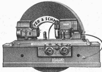
Machines à rectifier à commande hydraulique
