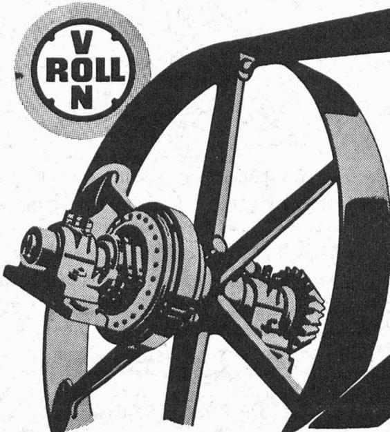
Embrayage électromagnétique à friction système Klus
