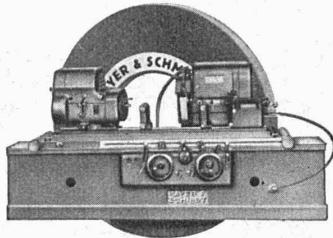
Machines à rectifier à commande hydraulique
