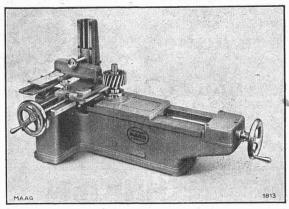
Appareil à contrôler le profil des dents, type FPV-40, avec enregistreur.
