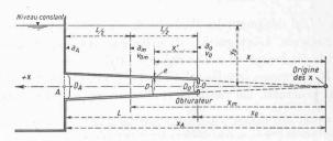
Fig. 1. - Schéma d'une conduite dont les caractéristiques varient linéairement le long de l'axe.
