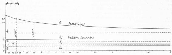
Fig. 5. — Courbes représentatives des demi-périodes apparentes  $\overline{\theta}$  en fonction de la caractéristique  $\sigma$ .
