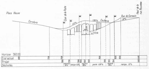
Fig. 8. — Pont de l'Ile. — Profil en long. — Echelles : longueurs 1 : 6000, hauteurs 1 : 600.
