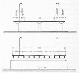
Fig. 13. — Pont du Mont-Blanc. Coupes transversales. — Echelle 1 : 600.
