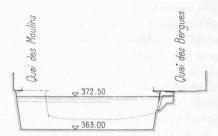
Fig. 15. — Quai des Bergues. — Profil en travers. Echelle : 1 : 1000.
