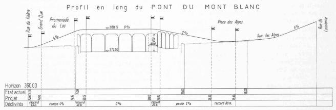
Fig. 4. — Pont du Mont-Blanc. — Profil en long. — Echelles : longueurs 1 : 6000, hauteurs 1 : 600.
