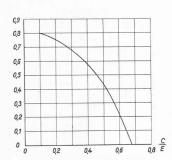
Fig. 15. — Rendements spécifiques  $R_s$  en fonction du rapport caractéristique C/E pour  $\eta_c = 0.8$  et  $\eta_e = 0.85$ .
