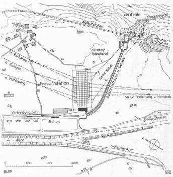
Fig. 15. — Plan de situation 1 : 8000 des installations d'Innertkirchen.
