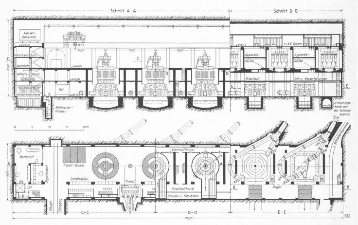
Fig. 18. — Usine d'Innertkirchen. — Coupes longitudinales, verticale A-A/B-B et horizontale C-C/D-D/E-E. Echelle 1:500.
