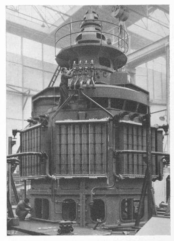
Fig. 21. — Un alternateur de 47 500 kVA, 13,5 kV, 428 tours/min en montage dans les Ateliers de construction Oerlikon. Poids total 250 t. PD<sup>2</sup> env. 600 tm<sup>2</sup>.
