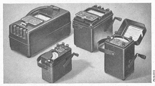
Mesureurs d'isolations, petits et grands modèles, mégohmètres pour résistances d'isolement jusqu'à 10 000 mégohms.
