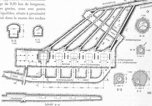
Fig. 6. — Usine d'Innertkirchen. — Coupe horizontale 1:1000 et profils-types.
