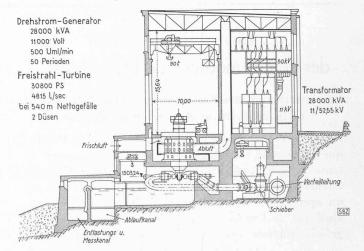
Fig. 2. — Usine de la Handeck — Coupe en travers 1:500.
