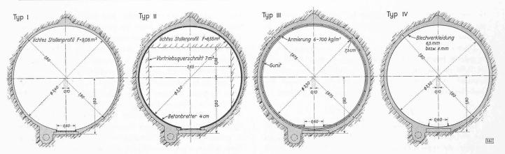
Fig. 8. — Les quatre profils-types de la galerie d'amenée. Echelle 1 : 80. (lichtes Stollenprofil = section libre — Vortriebsquerschnitt = section d'avancement).
