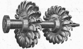
Nouvelles roues motrices des Turbines Pelton de 14,000 CV de la Centrale C. F. F. d'Amsteg.
