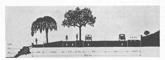
Fig. 5. — Route de Thonon élargie. Profil entre le Port Noir et la rampe de Vésenaz (en exécution).
