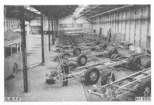
Fig. 10. — Montage des trolleybus en série.
