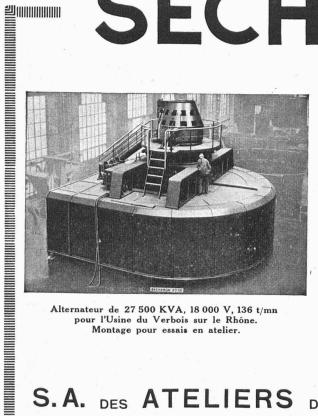
Alternateur de 27 500 KVA, 18 000 V, 136 t/mn pour l'Usine du Verbois sur le Rhône. Montage pour essais en atelier.
