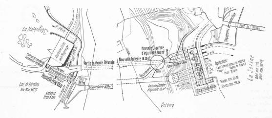
Fig. 1. — Usine hydro-électrique de l'Oelberg. — Plan de situation.
