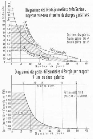
Fig. 4. — Usine hydro-électrique de l'Oelberg. — Comparaison des pertes d'énergie annuelles pour une ou deux galeries.
