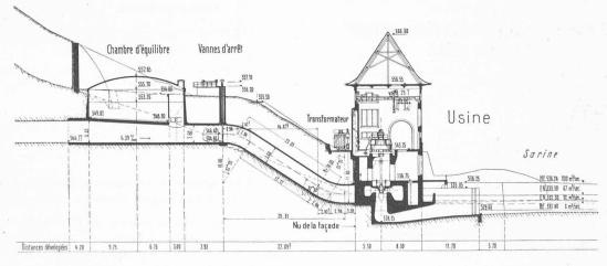
Fig. 2. — Usine hydro-électrique de l'Oelberg. — Coupe transversale de l'usine avec conduite forcée et chambre d'équilibre.
