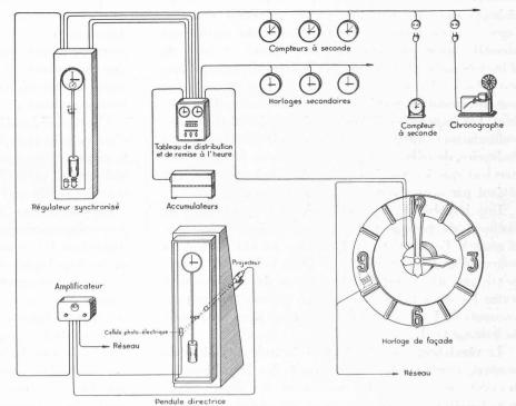
Fig. 25. — Réseau d'unification de l'heure du Laboratoire de recherches horlogères. Système Favag.
