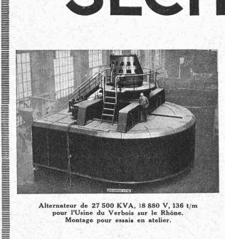
Alternateur de 27 500 KVA, 18 880 V, 136 t/m pour l'Usine du Verbois sur le Rhône. Montage pour essais en atelier.
