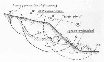
Fig. 11. — Mécanisme des glissements ayant affecté les terrains devant servir d'appui au bajoyer rive gauche du canal de fuite.
