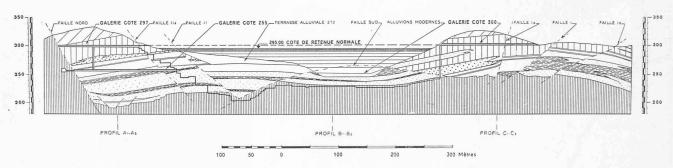
Fig. 3. — Profil géologique suivant les ouvrages principaux d'étanchéité.
