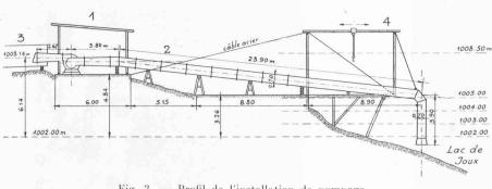
Fig. 3. — Profil de l'installation de pompage.
