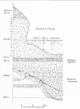
Fig. 3. — Pont Butin : fondations de la pile de rive droite.
