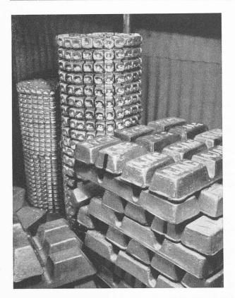
Fig. 4. — Lingots d'aluminium brut.
