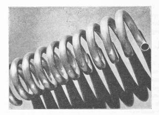
Fig. 11. — Travaux de pliage, serpentin pour l'industrie chimique.
