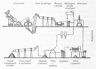
Fig. 1. — Fabrication de l'alumin , schéma (procédé Bayer).
