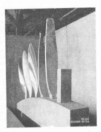
Fig. 10. - Travaux de forge, hélices d'avion.
