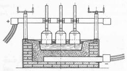
Fig. 3. — Cuve à l'électrolyse.
