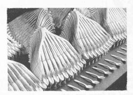
Fig. 6. — Fonte en coquille, pièces délicates.
