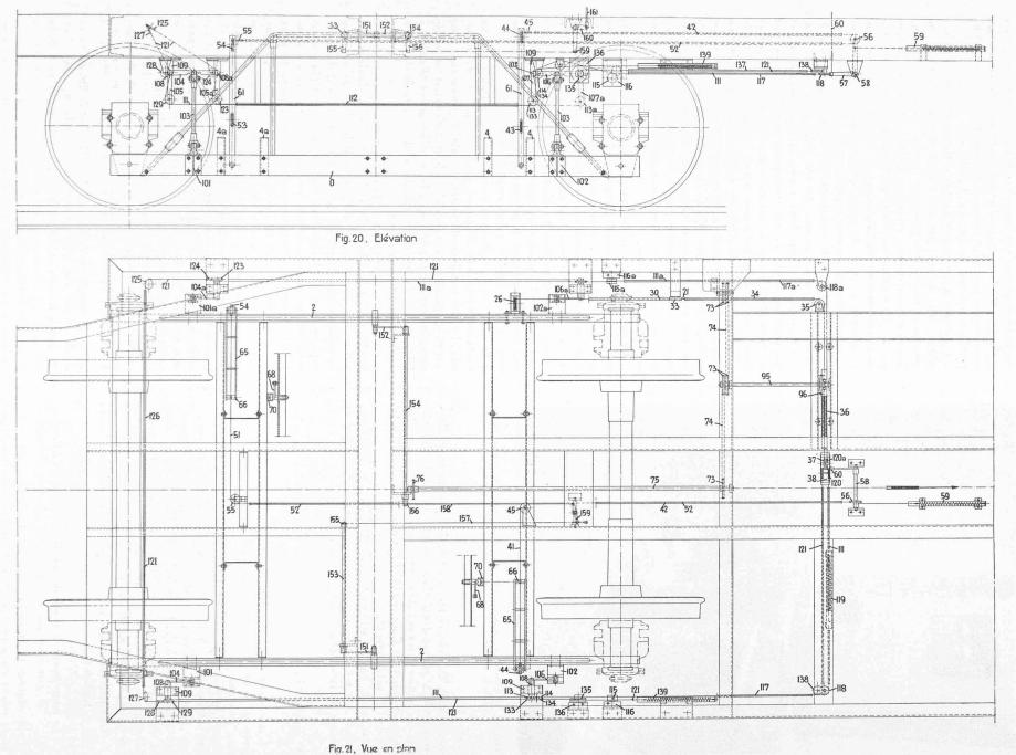
Fig. 20 et 21. — Bogie explorateur avec dispositifs pour la mesure des inégalités et du gauchissement. Elévation et plan. Echelle 1:25.
