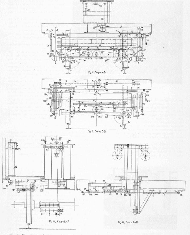
Fig. 12 à 15. — Bogie explorateur avec dispositifs pour la mesure de l'écartement et de la courbure et le rabattement des palpeurs. Coupes. Echelle 1 : 25.
