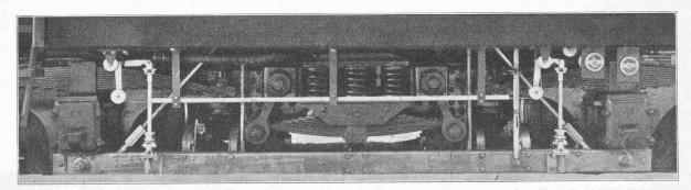
Fig. 22. — Bogie explorateur avec dispositifs pour la mesure des inégalités et du gauchissement. Vue de droite.
