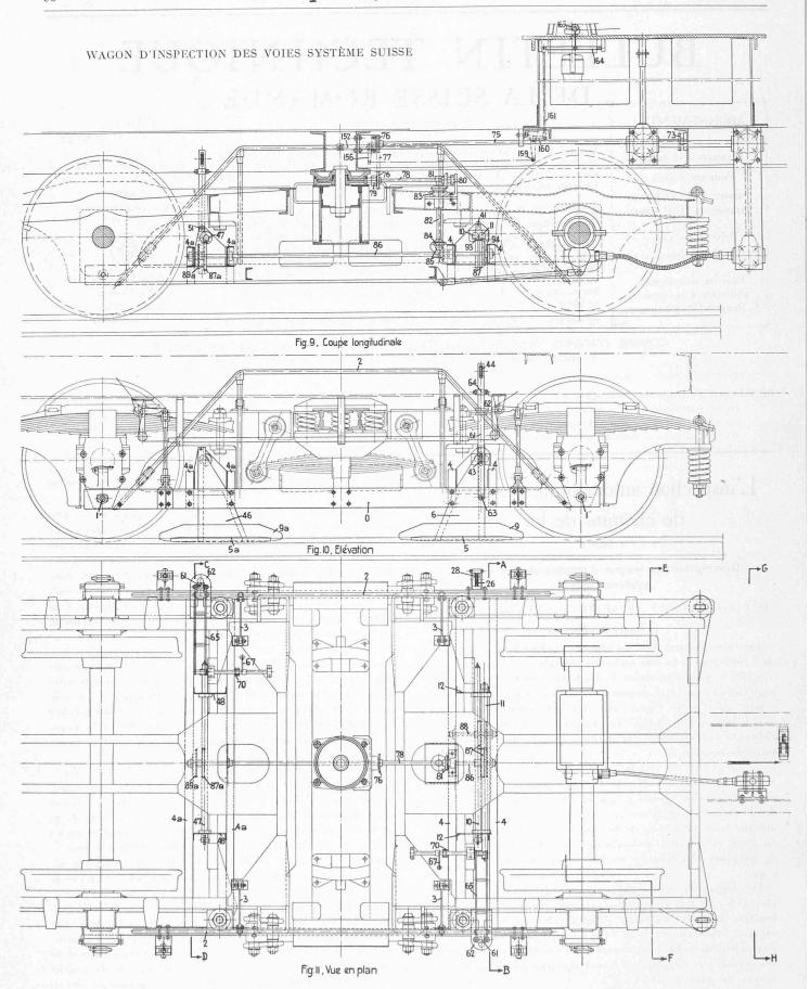
Fig. 9 à 11. — Bogie explorateur avec dispositifs pour la mesure de l'écartement et de la courbure et le rabattement des palpeurs. Elévation et plan. Echelle 1:25.
