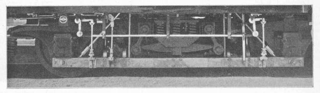
Fig. 23. — Bogie explorateur avec dispositifs pour la mesure des inégalités et du gauchissement. Vue de gauche.
