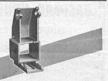
Cette pièce en laiton coulée par le procédé fonte injectée possède des parois de 2 et 2 1/2 mm. d'épaisseur. Le métal permettant d'obtenir des cotes exactes, les travaux d'usinage sont réduits au mini-mum. Ce sont deux avantages qui ne peuvent être obtenus par aucun autre procédé.
