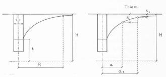
Fig. 1. — Perméabilité d'un terrain, déterminée par essai de pompage.
