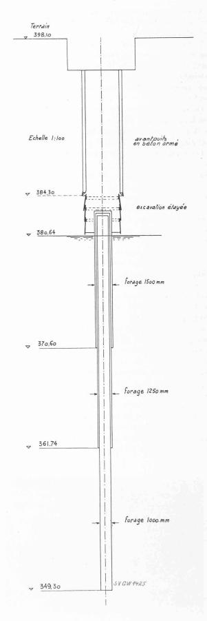
Fig. 5. — Schéma de l'ouvrage en cours d'exécution,
