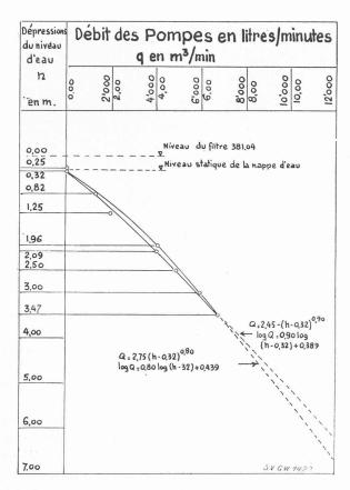
Fig. 9. — Diagramme de rendement du puits.
