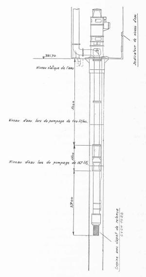
Fig. 10. — Pompe et moteur d'entraînement, au fond de l'avant-puits.
