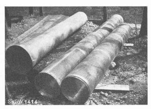
Fig. 6. — Cuvelage perforé, en acier inoxydable.
