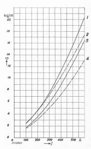
Fig. 3. — Poids, en kg/m, des câbles basse tension équivalents à trois conducteurs en aluminum et en
