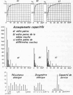
Fig. 4. — Câble téléphonique, 40 paires 1,3 mm Ø, conducteurs en aluminium.
