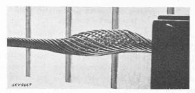
Fig. 2. — Gonflement d'un câble aluminium-acier après rupture.
