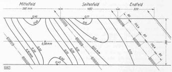
Fig. 2. — Courbes d'égal fléchissement du modèle pour une charge de 125,5 kg uniformément répartie sur la travée centrale. Mittelfeld : Travée centrale. — Seitenfeld : Travée latérale. Endfeld : Travée extrême.
