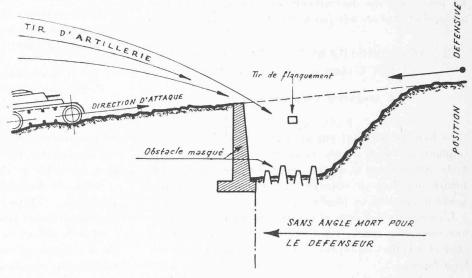
Fig. 5. — Mur en contre-escarpe masqué.
