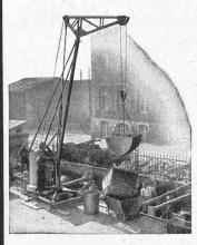
Tous les arbres d'engre-nage de la petite grue RACO tournent dans des roulements à billes de précision et ne sont, de ce fait, soumis pratiquement à aucune usure. Le treuil et le moteur, montés dans une cabine de protec-tion fermant à clef, sont d'un accès facile. Tout recul de la charge est rendu impossible par l'action de cliquets de sûre é et un frein à contrepoids. Un câble antigiratoire sert d'organe de levage et la poulie à câble peut servir pour l'élévation directe ou mouflée.
