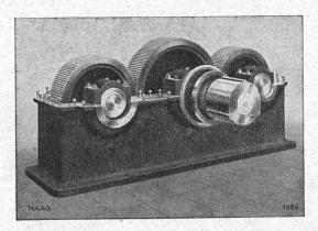
Réducteur de vitesse pour 13 000 CV entre moteur électrique et deux pompes centrifuges. Denture rectifiée sur machine Maag.
