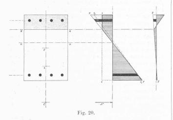
Admettons que la sollicitation ainsi définie détermine dans le béton des tensions positives dépassant la limite d'élasticité de ce matériau, et que, par conséquent, elle donne naissance à des déformations plastiques.
