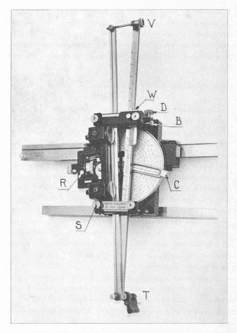
Fig. 4. — Intégrateur d'altitudes de Jean Lugeon. Constructeur: K. Hünenberger, Zürich IX.
