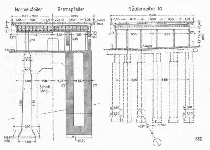
Fig. 48. — Divers types de construction du lot 5. (La profondeur des fondations est variable) Echelle 1:400. La fondation de la pile supportant l'effort de freinage est formée, à partir de la cote 535 environ de 8 puits Ø 1,8 m. Pile normale. Pile de freinage. Série de colonnes 10.
