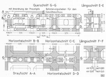
Fig. 41. — Dispositif au sommet de la grande voûte pour la mise en tension et le réglage (à la clé). 20 vérins de 330 t de capacité.
