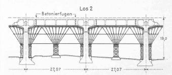
Fig. 24. — Type d'échafaudage du lot 2. Echelle 1 : 800, Betonierfugen = joints de reprise du bétonnage.
