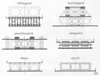
Fig. 36. — Systèmes de cintres pour l'exécution des grandes voûtes.
