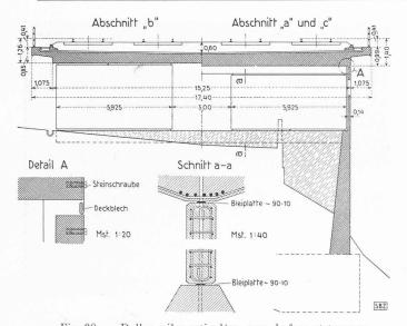
Fig. 30. — Dalles, piles articulées, mur de face et tympan. Abschnitt = tronçon — Schnitt  $a \cdot a = \text{coupe} \ a \cdot a - \text{Steinschraube} = \text{boulon de scellement} — Deckblech = couvre-joint en tôle — Bleiplatte = plaque en plomb — Mst. 1: 40 = échelle 1: 40.$
