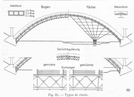
Hohlform = forme évidée — Massivform = forme à section pleine — Ring = anneau — Bogen = arc — Fächer = éventail — Gerüstregulierung = réglage du cintre — Gurtungen = membrures — geknickte = à brisures — gekrümmte = en courbe.
