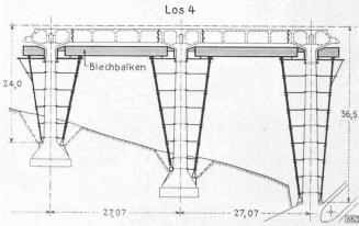
Fig. 25. — Type d'échafaudage du lot 4, avec utilisation de poutres métalliques assemblées par soudure.
